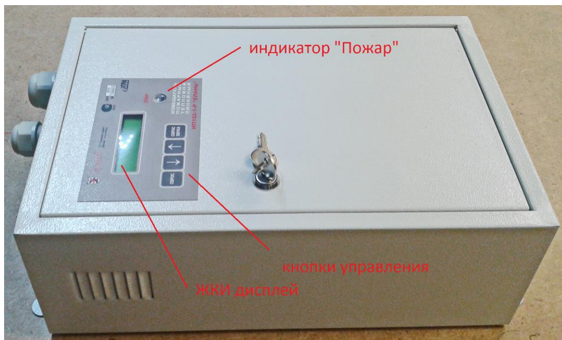
Рис.1.1 - Блок обработки ИП132-1-Р «Елань». Эксплуатационное положение дверцы
