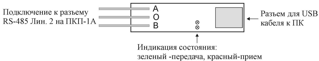
Рис.19 Расположение контактов ПИ1
